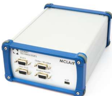
Fig. 2.cj: MCLA18 \pm 32V/1A driver
